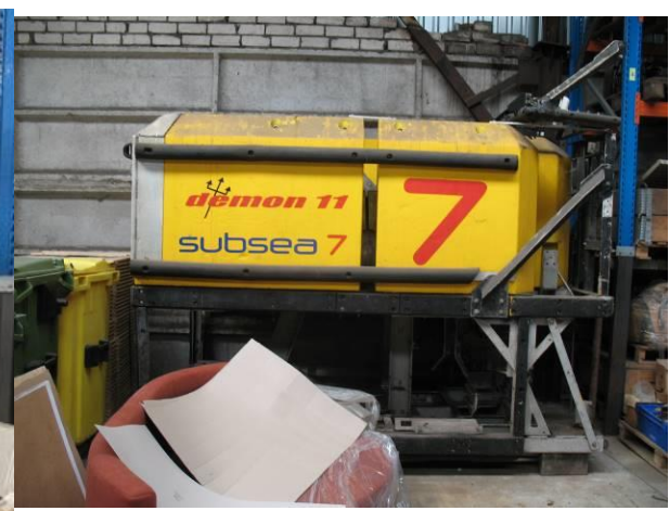
Zemūdens darba klases robota “Demon” sistēma
