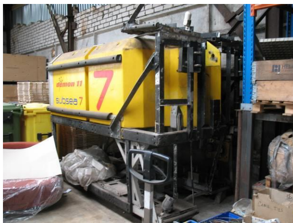
Zemūdens darba klases robota “Demon” sistēma
