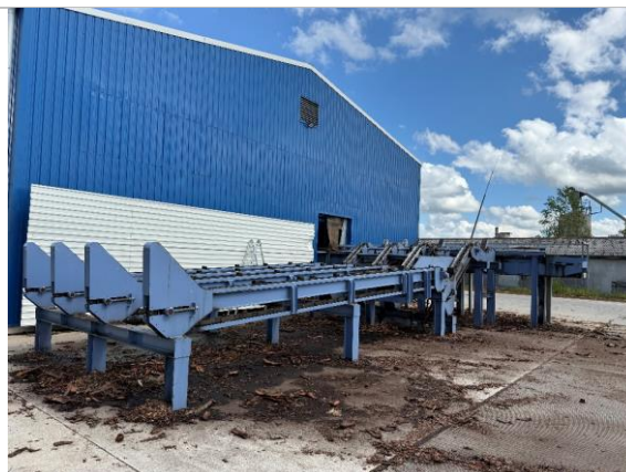
Kokapstrādes līnija Primultini - baļķu uzkrāšanas rampa
