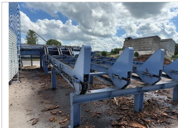
Kokapstrādes līnija Primultini - baļķu uzkrāšanas rampa
