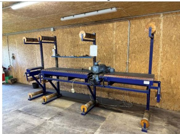
Zāgu lentas spriegošanas iekārta Primultini BC
