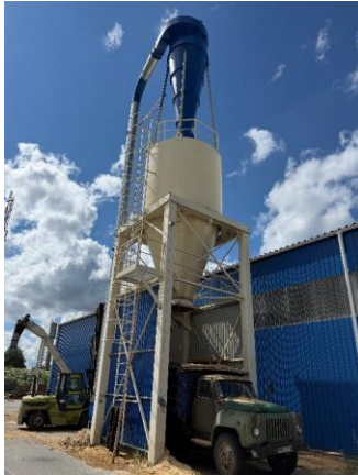
Skaidu bunkurs ( V=40\text{ m}^3 ) uz balsta
