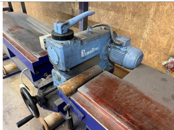
Zāgu lentas spriegošanas iekārta Primultini BC
