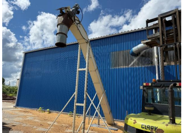
Skaidu izlādes ķēdes konveijers ( L=17\text{m} , jauda 3 kW)
