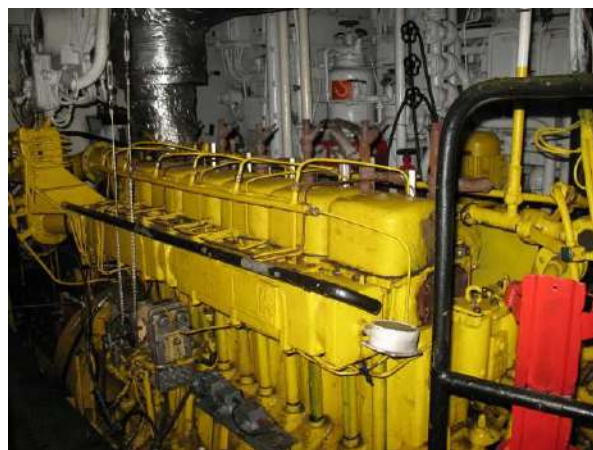
Kuģa aprīkojums un galvenais dzinējs 6NVD-26A
